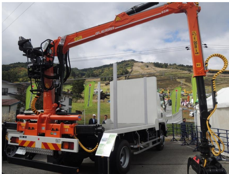
中型運転免許で運転できるクラスの木材運搬トラック
