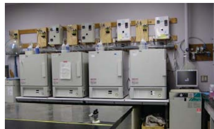
写真2 小容積堆肥化実験装置
