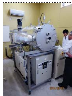
写真2 ブランチング・殺菌・減圧乾燥装置
