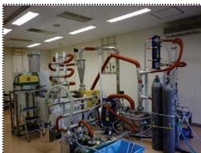
写真1 粉体用閉回路型低酸素加熱殺菌装置
