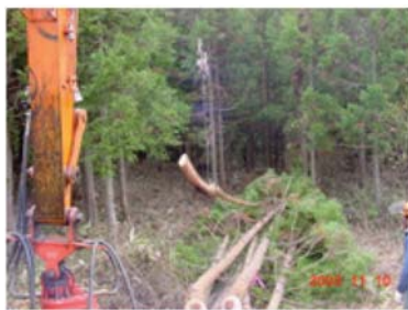
写真1 スイングヤードによる列状間伐木の集材試験
