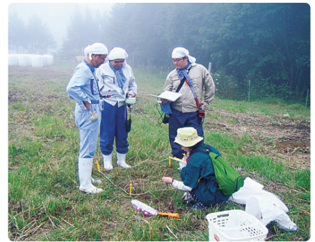
1m放射線量測定と草、土試料の採取
